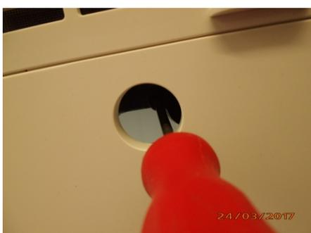
Nimm einen Schraubenzieher zur Hilfe und reinige den Wasserauslass durch Drehen. Kleiner Tipp: Du kannst ein dünnes Reinigungstuch um den Schraubenzieher wickeln.
